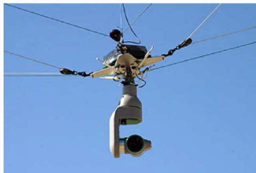
(b) Cablecam, versione commerciale di Skycam ([www.cablecam.com](http://www.cablecam.com))
