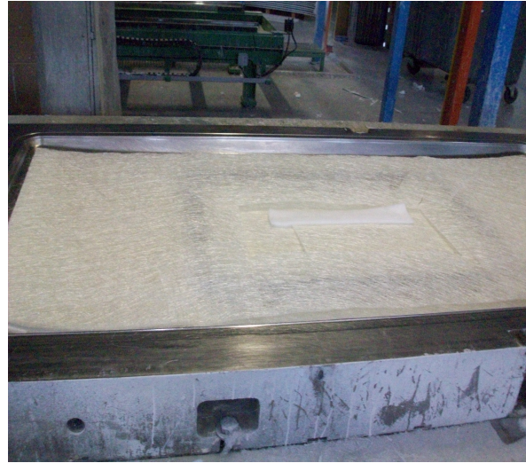
Figura 2.4 Sempre lo stesso stampo sul quale sono stati applicati gli strati di mat unifilo e un inserto in poliuretano espanso
