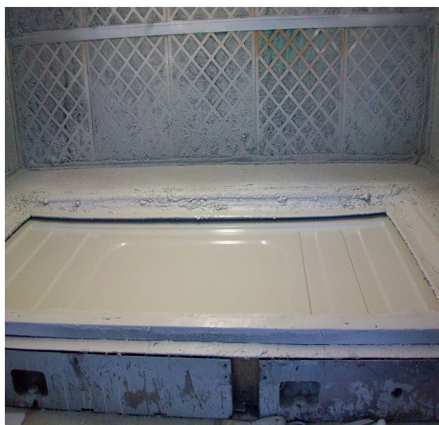
Figura 2.3 Stampo di un tetto per camion su cui è stato applicato il gelcoat
