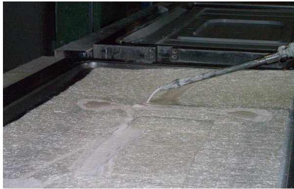
Figura 2.6: operazione di deposizione della miscela
