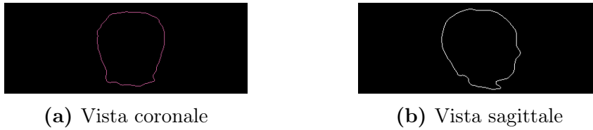
Figura 3.7: Esempio di applicazione dell'algoritmo di Suzuki e Abe alle immagini di Figura 3.6
