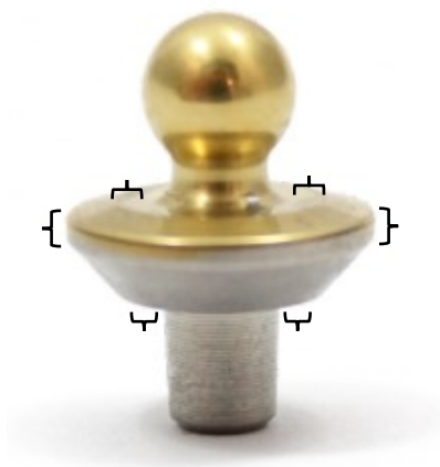
Fig. 3.5 Possibili regioni di contatto supporto-colletto bipolare.
