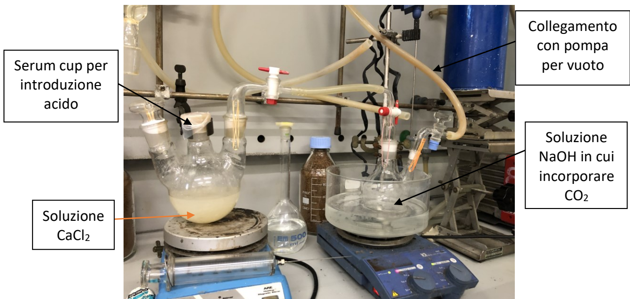
Figura 14: Dispositivo allestito in laboratorio per le reazioni studiate di trattamento con acidi forti di CaCO 3 e contemporaneo intrappolamento di CO 2 .
