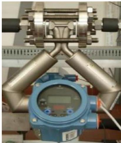
*Figura 6. Misuratore di portata ad effetto Coriolis*
