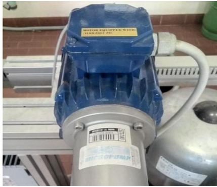
*Figura 5. Pompa a ingranaggi a trascinamento magnetico*
