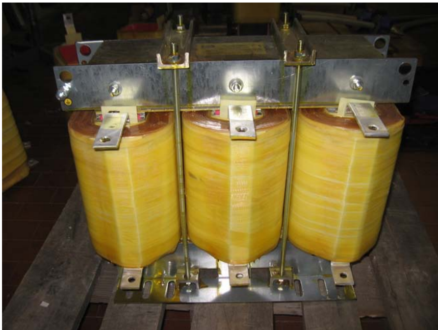
Figura 12.1: Reattore trifase realizzato da Euroelettro
