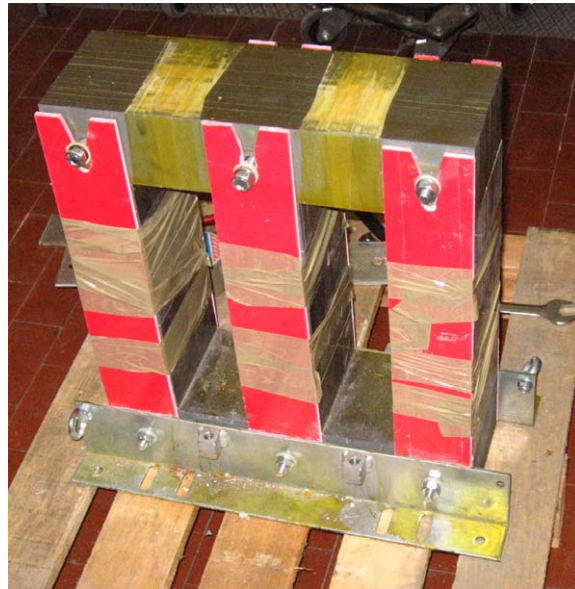
Figura 15.2: Nucleo reattore prototipo oggetto della tesi
