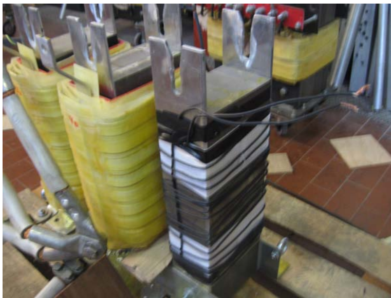
Figura 14.4: Realizzazione avvolgimento per valutare le perdite nel ferro
