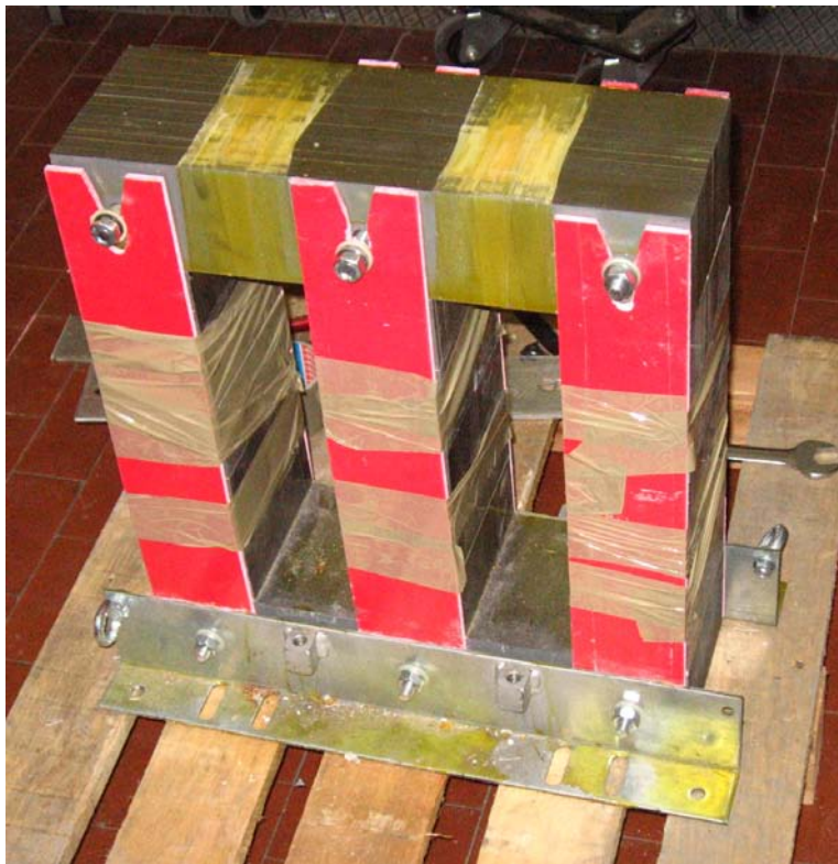
Figura 12.2: Nucleo della reattanza prototipo.
