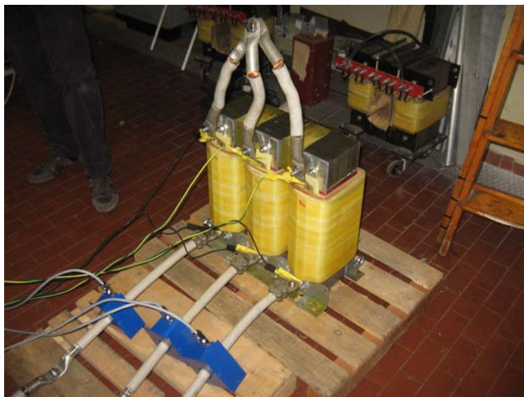
Figura 15.3: Misura potenza reattore
