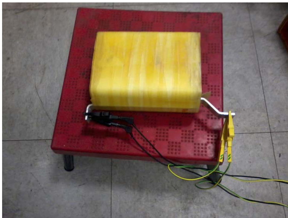
Figura 13.1: Prova AC su uno degli avvolgimenti a disposizione.
