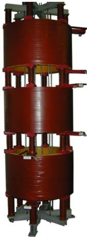
Figura 1.2: L'immagine sopra riportata un reattore trifase per linea da 15 kV, induttanza di 16 mH, corrente nominale 218 A e corrente di cortocircuito 1180 A.
