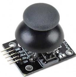
Il joystick è un sensore tipo encoder che si collega ad Arduino come INPUT.
