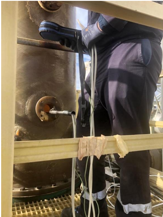
Fig.6 Personale del laboratorio che effettua la misura di portata con un tubo di Pitot.
