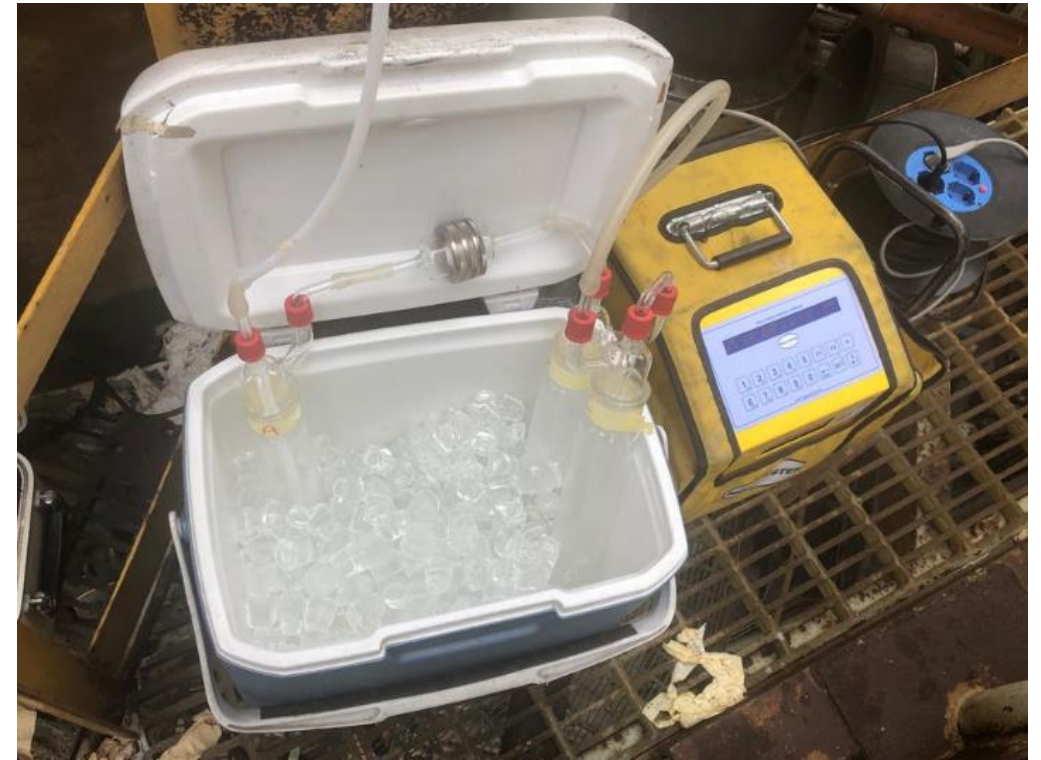
Fig.8 Il gas prelevato passa per il treno di gorgogliatori: -il primo ha 100ml di isopropanolo 80% in \text{H}_2\text{O} demi per \text{SO}_3 ; -il secondo e terzo 100ml di \text{H}_2\text{O}_2 al 3% in \text{H}_2\text{O} demi per \text{SO}_2 .
