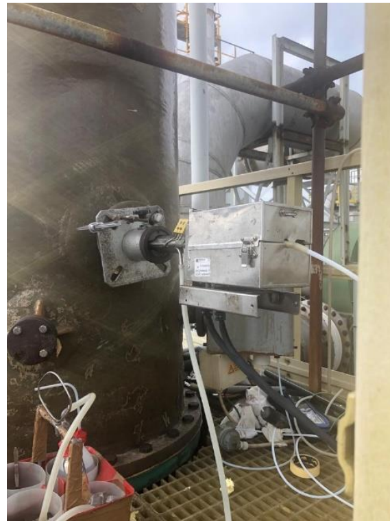
Fig.7 Sonda riscaldata nella presa campione, con tubo di Pitot incorporato .
