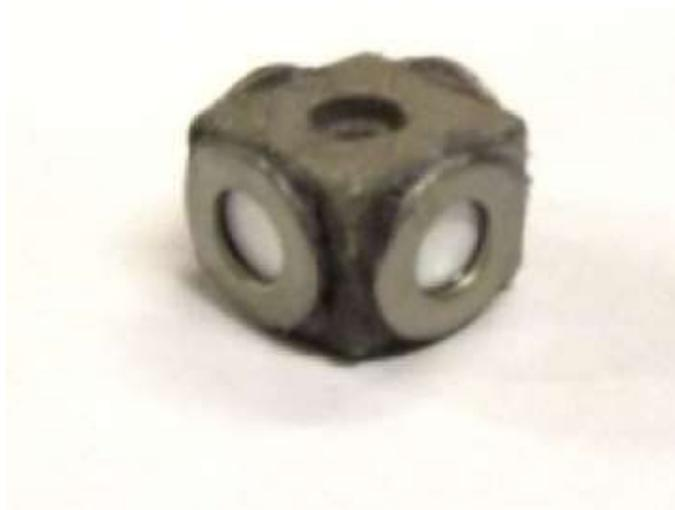
Figura 2.1 Cubo in lega di titanio con canali interni
