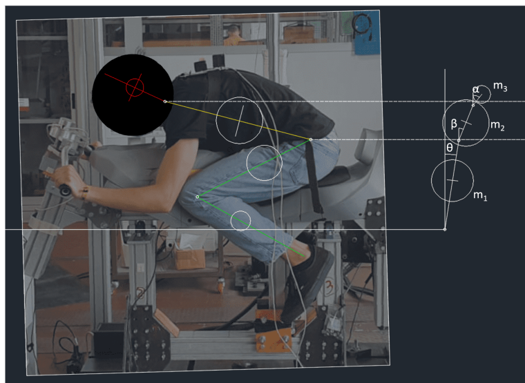
Figura 6.22: ACCELERATION - Pilota 2 modellizzato con modello a 2 DOF (\beta, \alpha)
