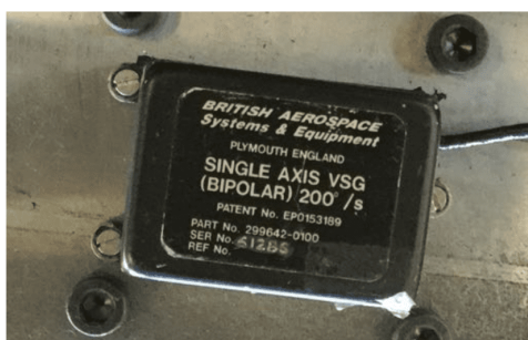
Figura 2.2: Giroscopio prodotto da BAE.
