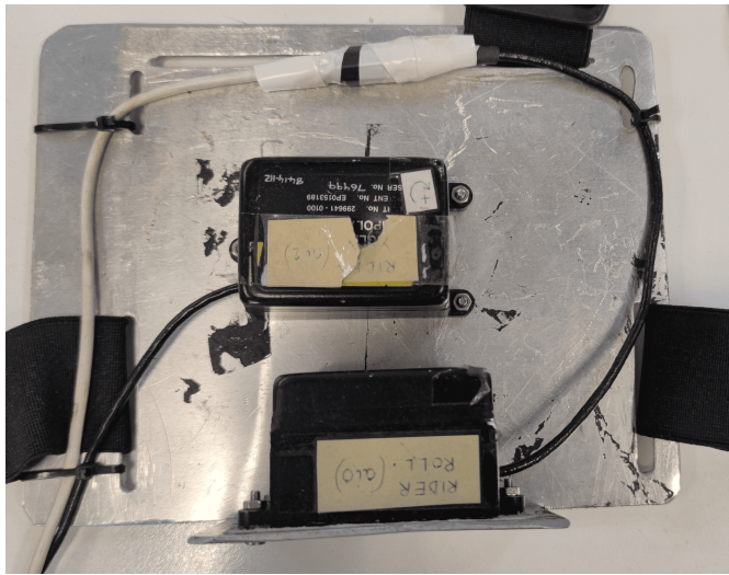
Figura 2.3: Pettorina utilizzata per i test.
