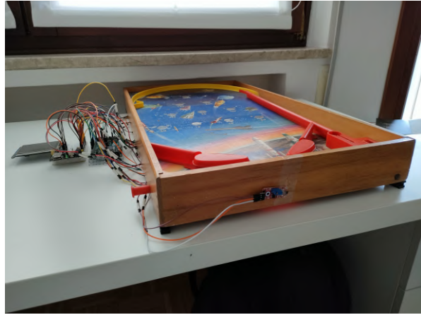
(b) Lato flipper: particolare del sensore per il conteggio delle palline rimanenti
