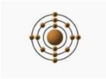
Figura 3.2 Configurazione elettronica Silicio (Si)
