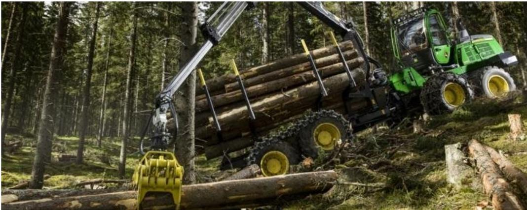
*Figura 1.2: immagine esemplificativa di un forwarder John Deere modello 1210 G.*
