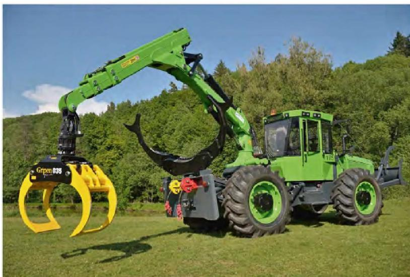
*Figura 3.1: Skidder Equus 175 UN completo di braccio idraulico, clambruck e verricello a doppio tambur. Foto da [www.equuseu.com](http://www.equuseu.com)*
