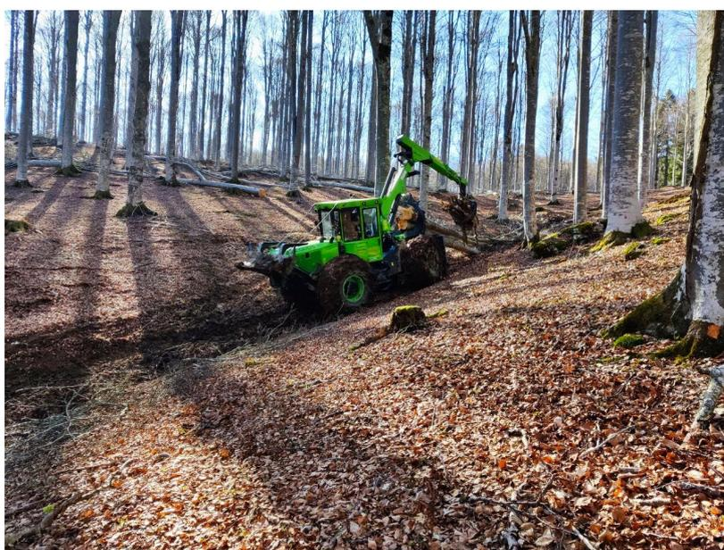
*Figura 1.1: fase di esbosco con lo skidder Equus 175 UN. Foto Piol Omar*
