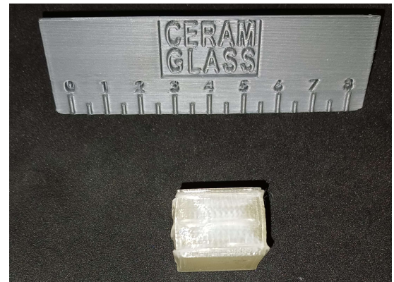
Figure 4.11: Grafico e relativo provino di PLA di compressione statica con il secondo macchinario
