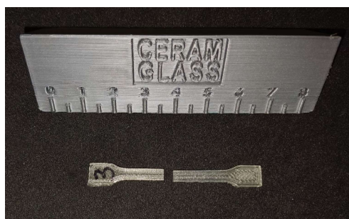
Figure 3.9: Foto provini PLA tipo 2 dopo il test di trazione
