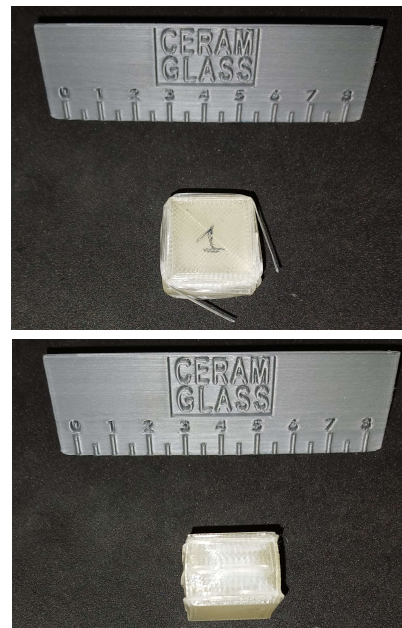
Figure 4.8: Grafico e relativo provino di PLA della prova a compressione statica
