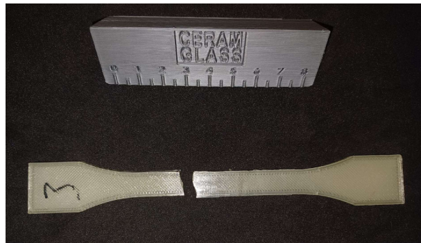
Figure 3.7: Foto provini PLA tipo 1 dopo il test di trazione
