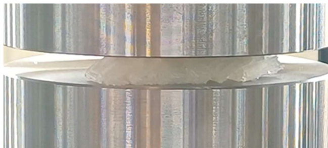
Figure 4.43: Provino PLA - TPU alla fine della prova di compressione statica
