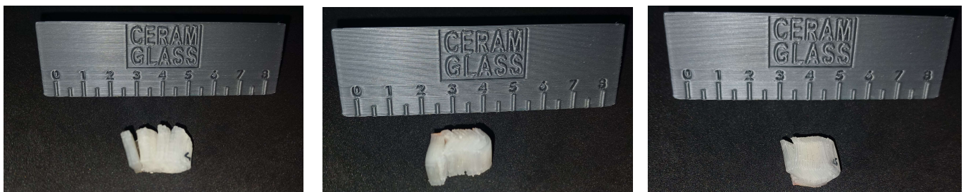
Figure 4.23: Provini PLA - TPU 0.2 orientamento perpendicolare dopo la prova
