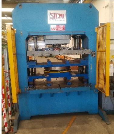
Fig. 4.2.5.7: pressa per la realizzazione dei fori per i torrini d'aerazione
