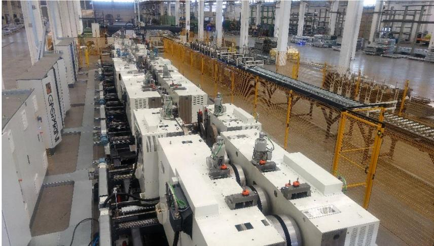
Fig. 4.2.4.3: linea continua per la realizzazione dei montanti
