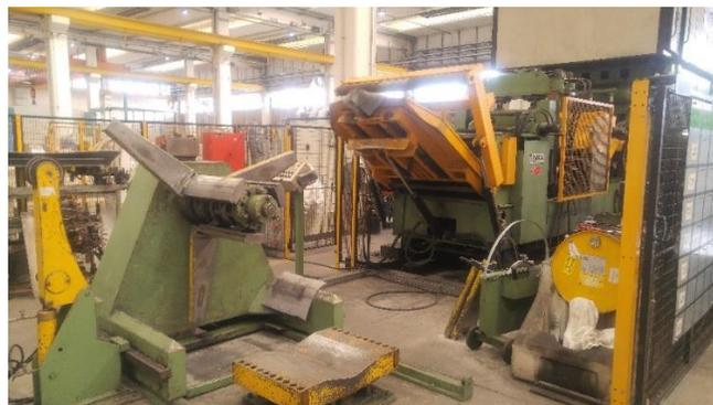
Fig. 4.2.3.3 aspo svolgitore della pressa per i montanti
