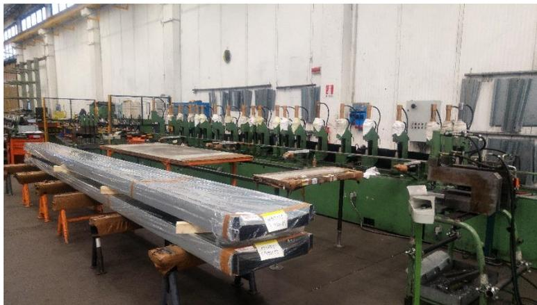
Fig. 4.2.5.4: profila per la realizzazione fori e greche degli spicchi tetto
