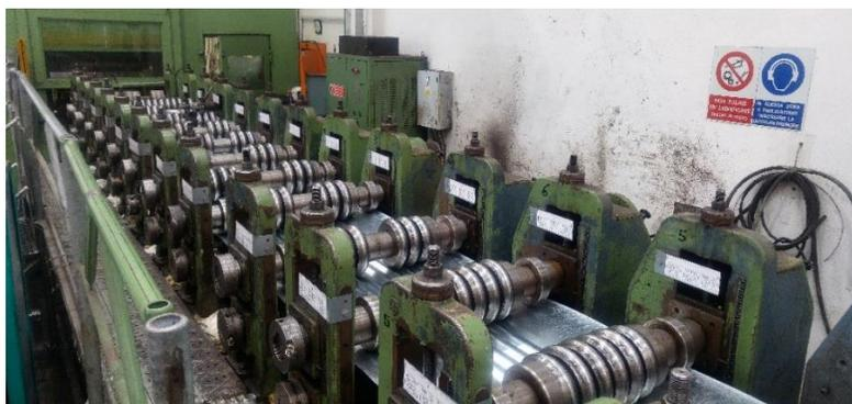
Fig. 4.2.1.4 rulliere di corrugazione lamiera nella profila
