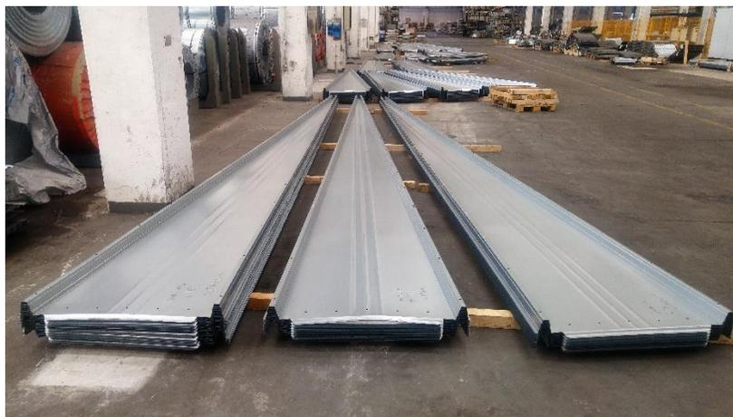
Fig. 4.2.5.5: spicchi tetto (WSC3) terminati e impilati
