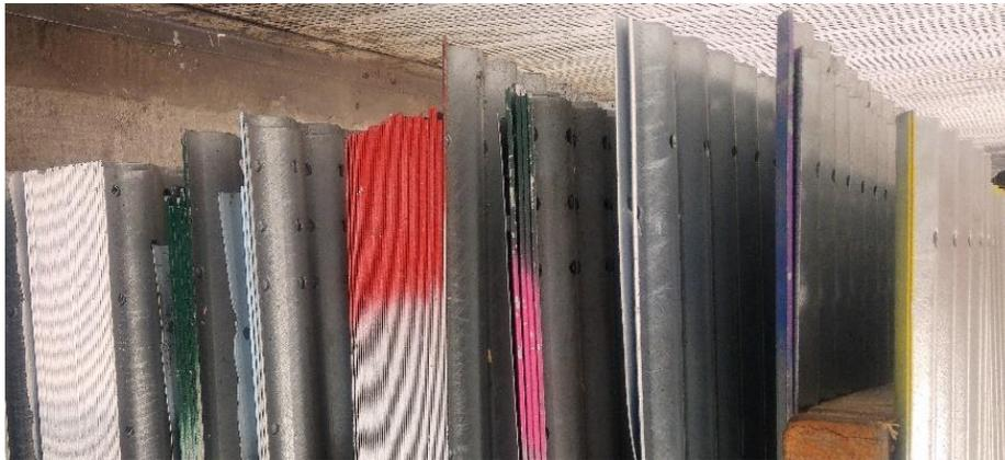
Fig. 4.2.1.7 colorazione laterale con spray per l'identificazione
