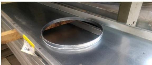
Fig. 4.2.5.6: spicchio con foro per l'alloggiamento del torrino di aerazione
