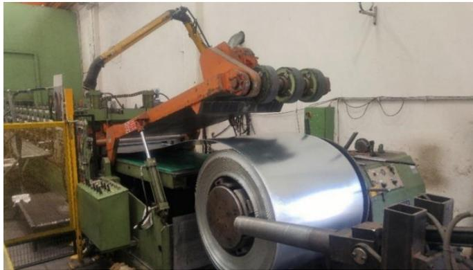
Fig. 4.2.1.3 aspo svolgitore e srotolamento nella profila
