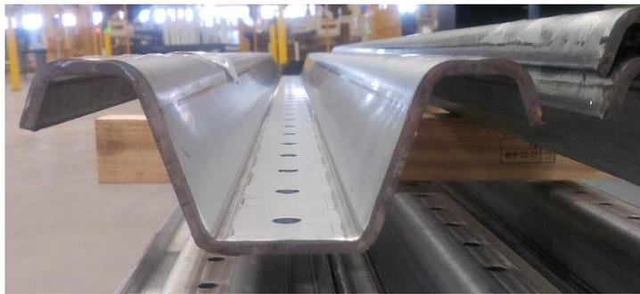
Fig. 4.2.4.2: profilo Omega del montante WSC3
