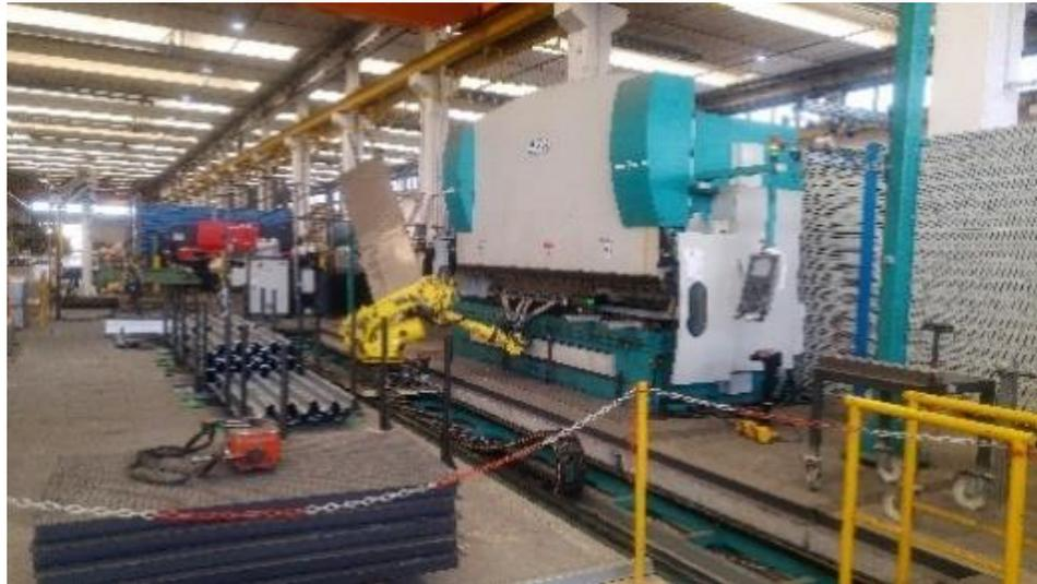
Fig. 4.2.3.6 robot per la piegatura
