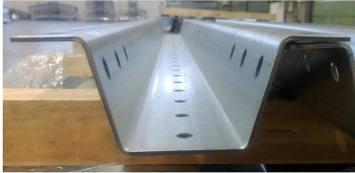
Fig. 4.2.4.1: profilo del montanti WSC2
