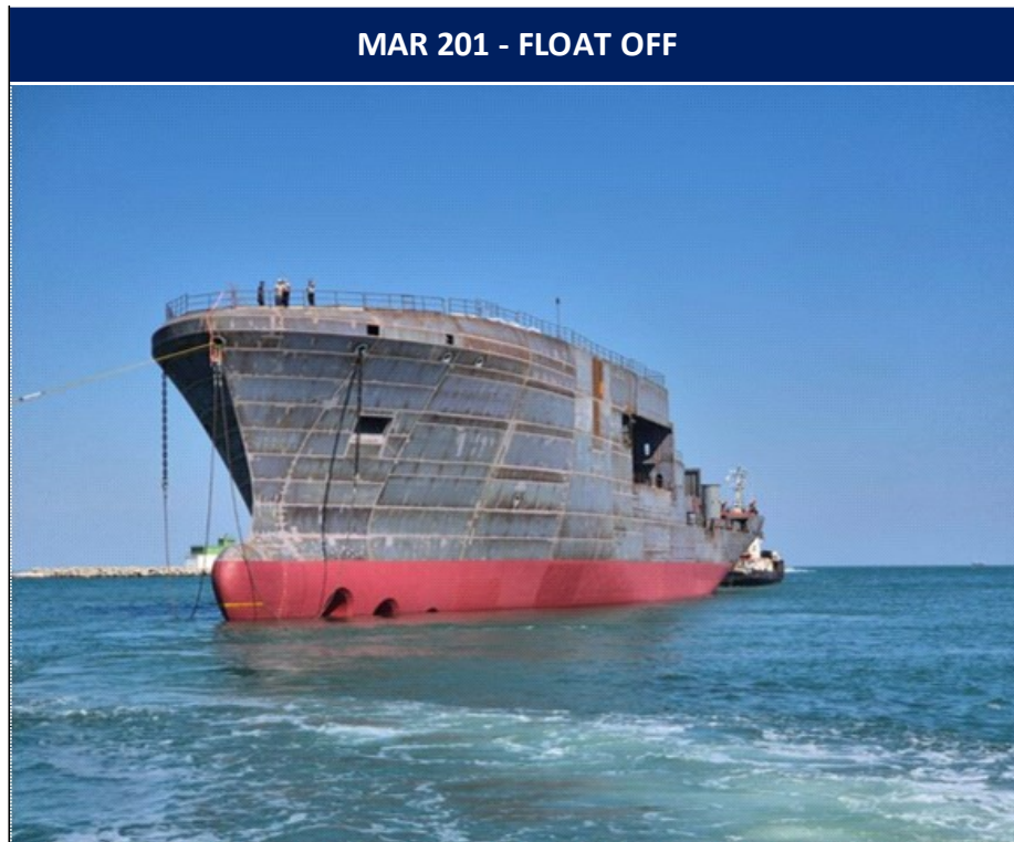
Figura 5.43 - Scafo della MAR201 durante la fase di "float-off"
