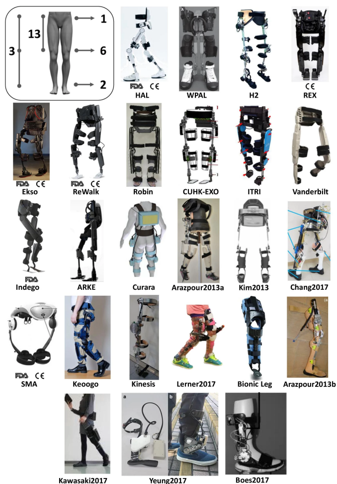
Figura 2.2: Esoscheletri per arti inferiori. L'immagine in alto a sinistra riassume le tipologie di esoscheletri in base alla disposizione degli attuatori.[11]
