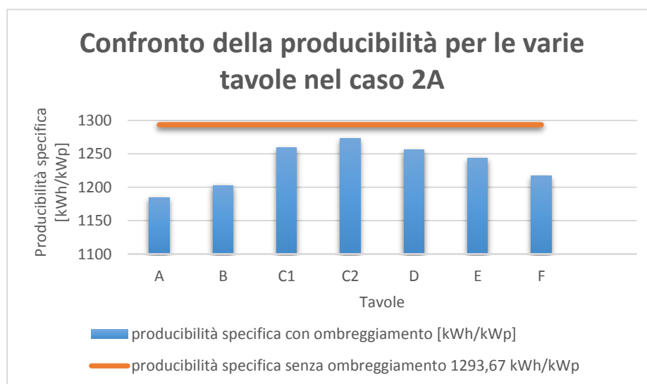
Figura 5.13: Confronto di producibilità specifica delle varie tavole nella caso 2A. La linea arancione fa riferimento alla producibilità specifica nel caso senza ombreggiamenti ed è pari a 1293,67 kWh/kWp.
