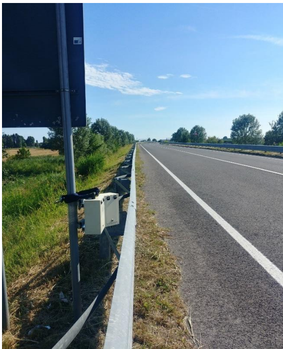
Figura 5 - Esempio di installazione del rilevatore di traffico
