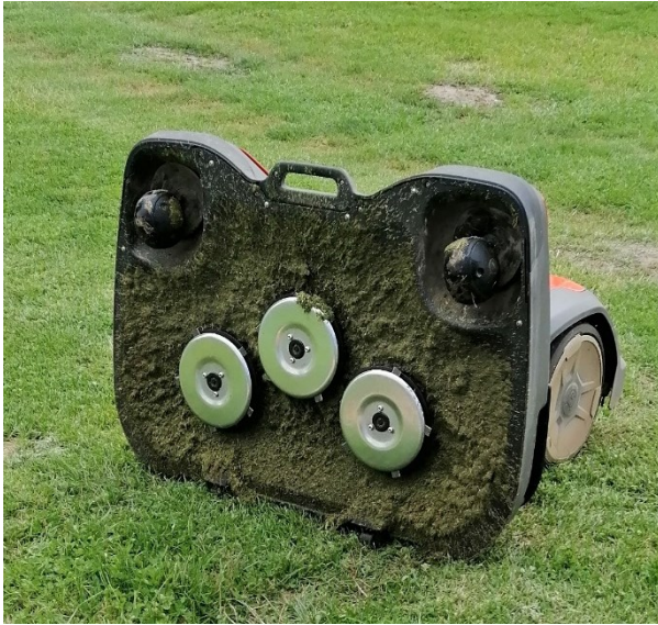
Figura 16. Apparato di taglio del robot tagliaerba (CEORA).
