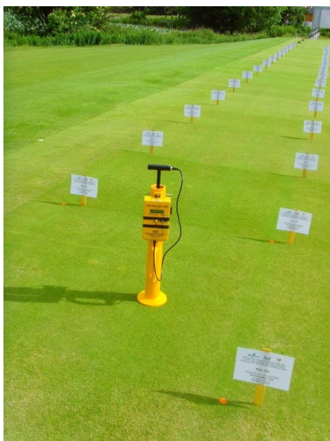
Figura 32. Impattometro di Clegg per determinare la durezza della superficie.
