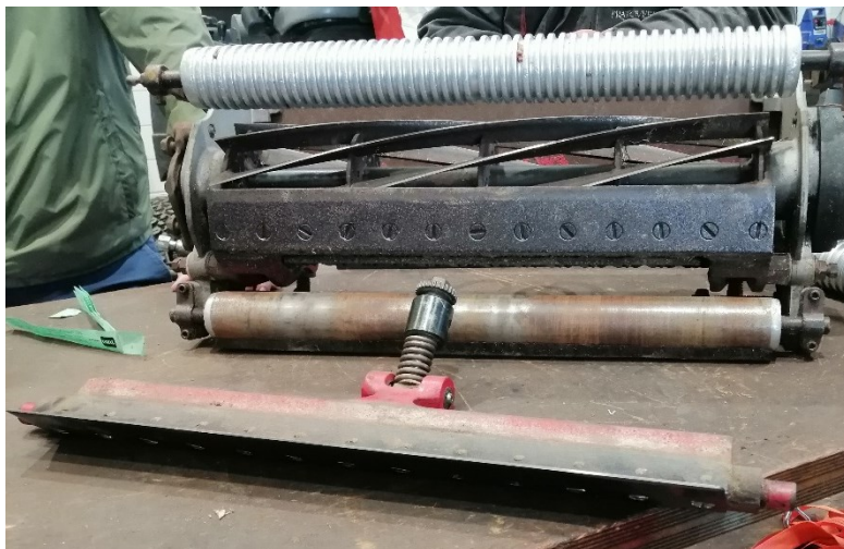
Figura 10. Apparato di taglio elicoidale sul tavolo di lavoro con contro lama smontata.
