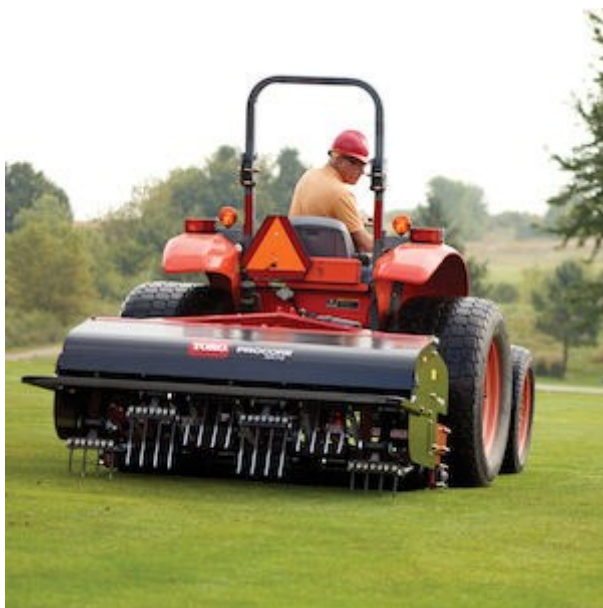
Figura 06. Arieggiatore per tappeti erbosi ProCore SR72 della Toro (sito Toro).
