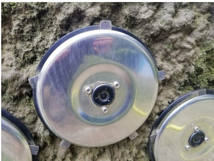
Figura 14. Disco rotante con lame (apparato di taglio del robot tagliaerba CEORA).
