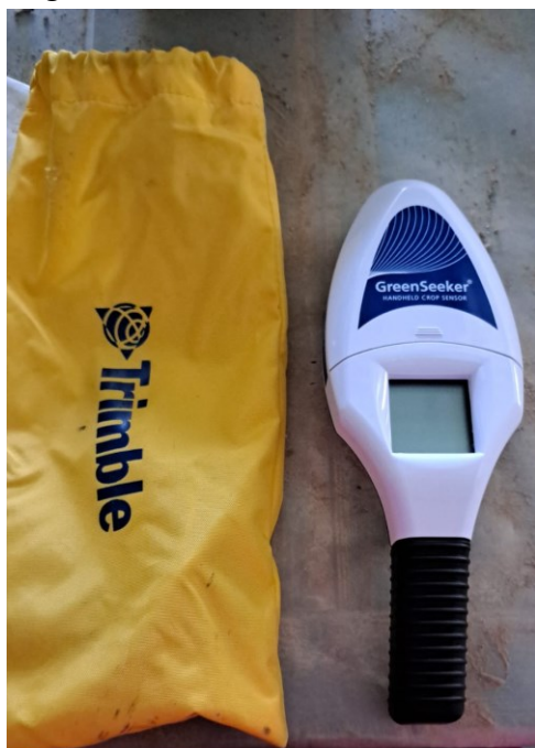
Figura 31. Riflettometro portatile per determinazione indice NDVI utilizzato in campo (GreenSeeker, Trimble Agriculture, California USA).
