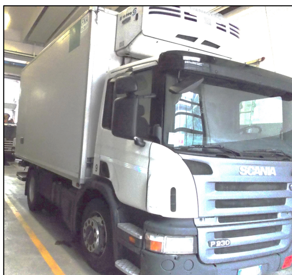
Figura 3.3.1b: Veicolo lunghezza utile interna 5,15 m
