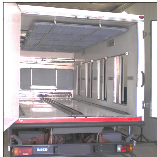
Figura 3.9b: interno con piastre eutettiche
