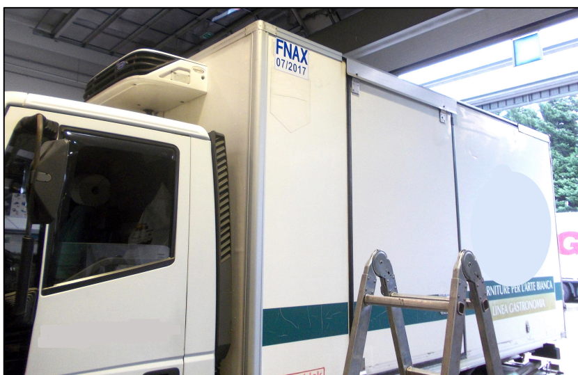
Figura 3.4b: Esempio di apertura laterale
