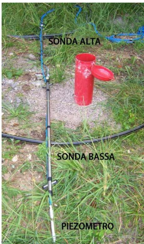
FIGURA 3.7 : Strumenti di misura posizionati nel giugno 2012
