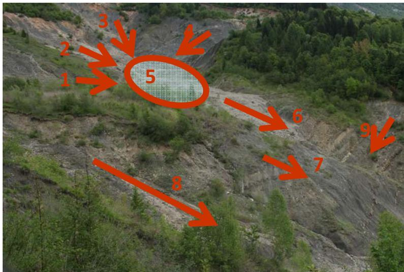
FIGURA 2.29 : Esempio di analisi visiva del movimento della colata con una serie di fotografie ad alta risoluzione
