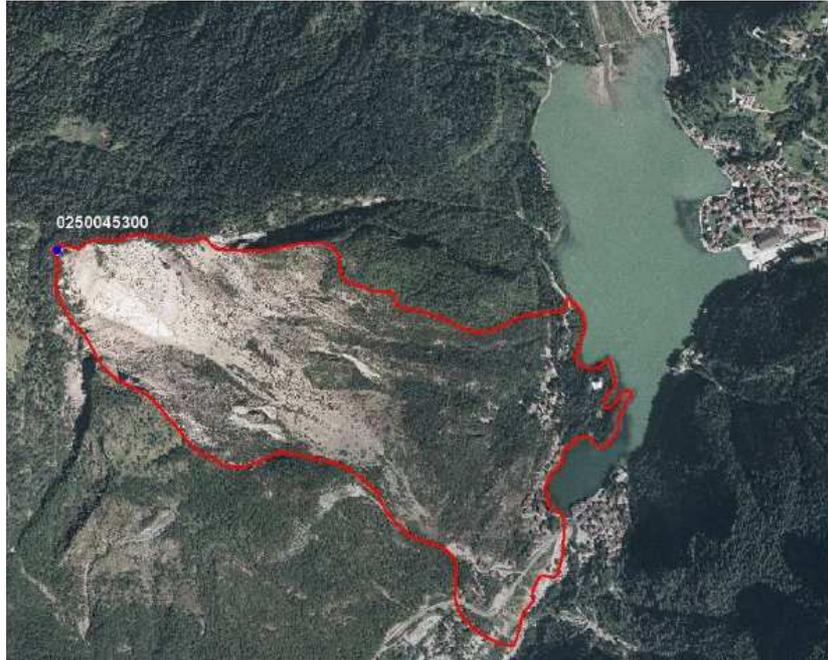
FIGURA 2.4 : la frana di Alleghe avvenuta con due successivi eventi nel 1771 ha provocato la formazione del lago omonimo ostruendo il corso del torrente Cordevole.
