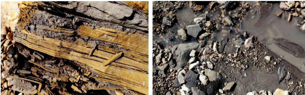
FIGURA 2.4 : Particolare di Flysch in stato roccioso in fase di alterazione (a) e in stato disgregato (b)
