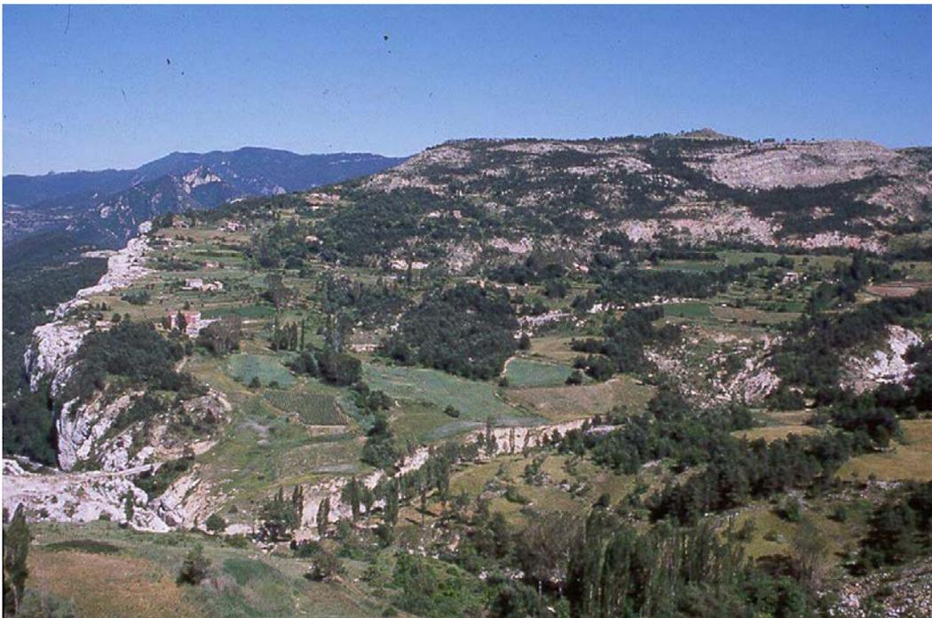
FIGURA 4.24 : Vista generale della frana traslazionale di Vallcebre. Il movimento è limitato, sul fondo, per l'alta scarpata di Serra de La Llacuna (centro-destra), in primo piano dal torrente Vallcebre, che va da destra a sinistra in un canale, e lateralmente da affioramenti di calcare grigio
