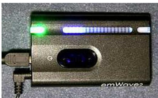
Fig.1.17 Fotopletismografo per la misura della HRV. [27]
