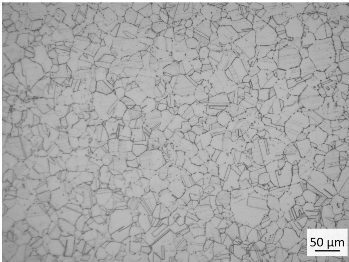
Figura 3.17 – Micrografia AISI 304L piastra base laminata a caldo, 16x
