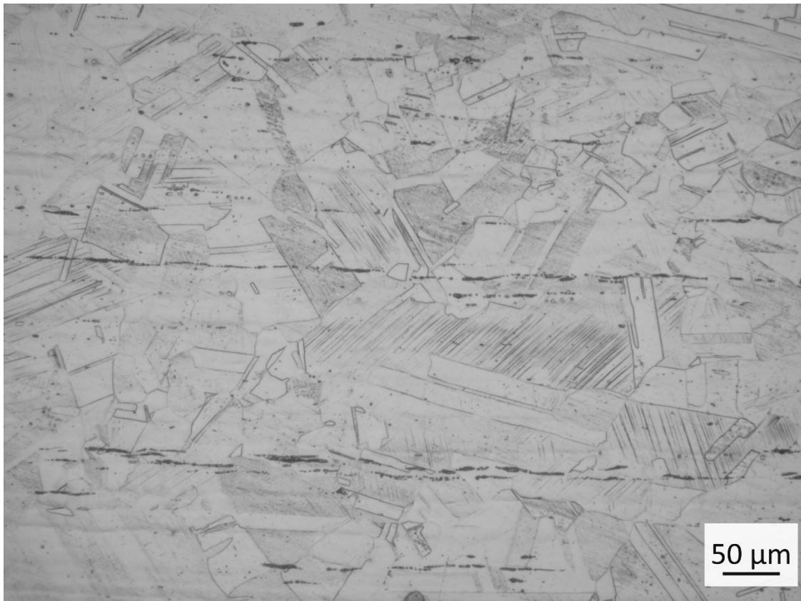
Figura 3.27 – Micrografia AISI 304L R-1_P_12 trafilato a freddo, 16x
