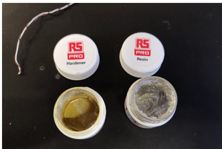
Figura 2.4 – Colla bi-componente; l'elemento in grigio rappresenta la resina conduttrice mentre l'elemento in beige è l'indurente.
