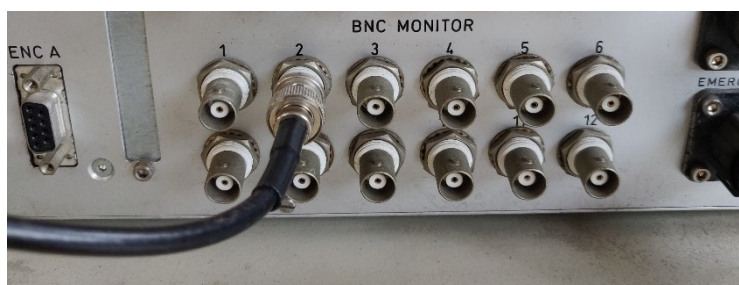
Figura 2.27 – La porta di collegamento del cavo lock-in con il controller RT3 è la numero 2.
