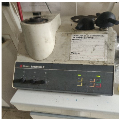
Figura 3.16 – Macchinario sciogli-resina e compattatore per inglobare i provini
