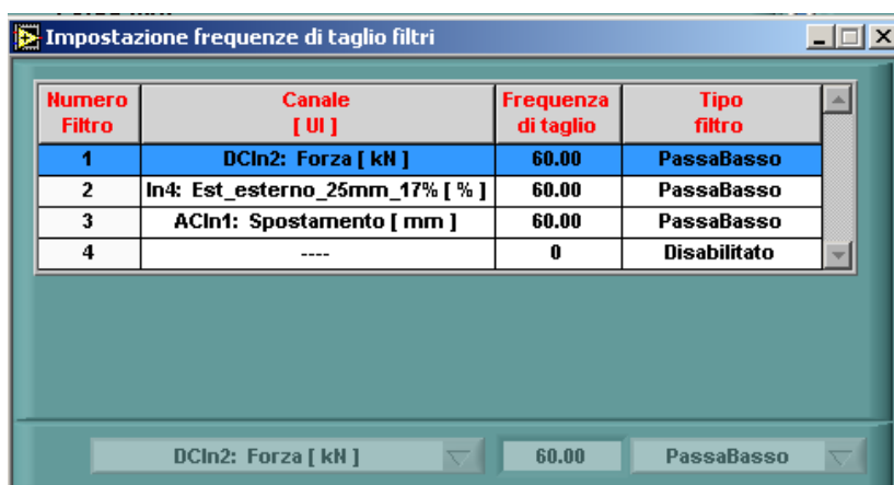
Figura 2.15 – Definizione dei filtri di ingresso analogici sui 3 canali di forza, spostamento ed estensometro.
