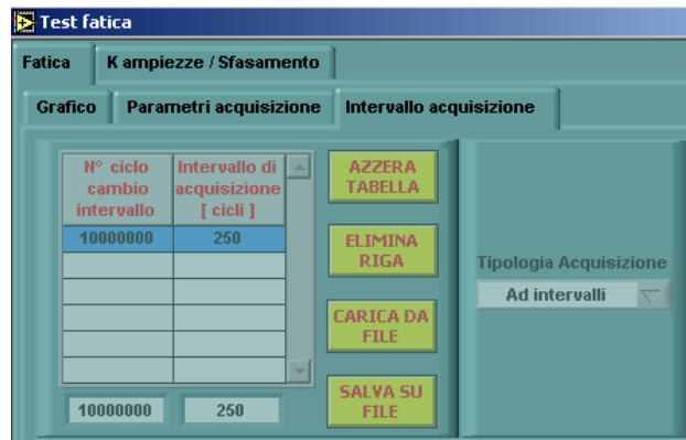
Figura 2.17 – Impostazione dell'intervallo di acquisizione. In questo esempio si acquisiscono i dati ogni 250 cicli.
