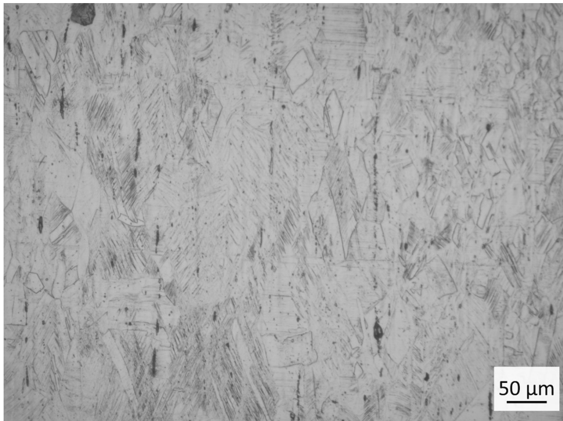
Figura 3.25 – Micrografia AISI 304L R01_P_14 trafilato a freddo, 16x
