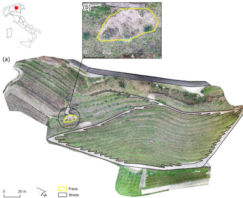
Figura 2.3 Panoramica dell'area studio (a) e focus sulla frana (b). L'ortofoto in figura 2a è stata elaborata mediante un precedente rilievo fotogrammetrico con drone
