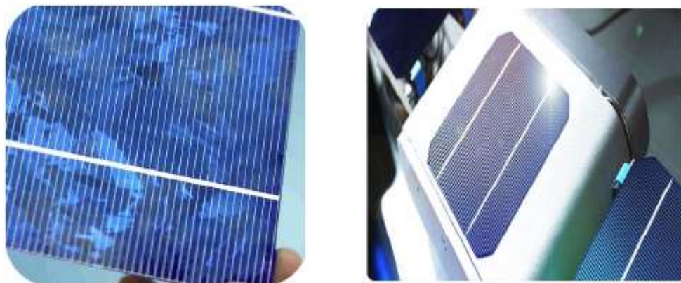
Fig8.4 Parte frontale di una cella solare. Si possono notare le sottili linee parallele dei contatti e le più larghe busbar .
