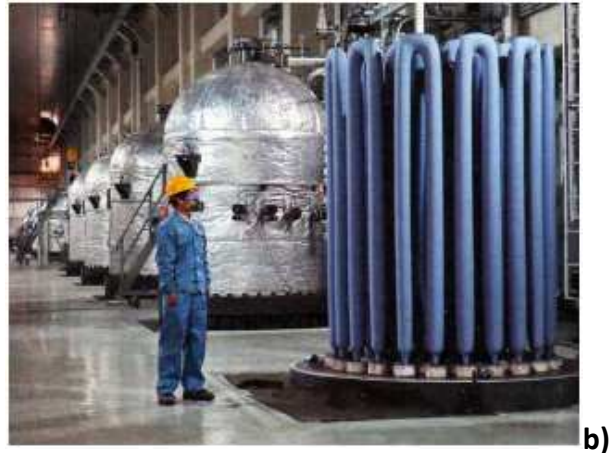
Fig.2.1 a) Schema del processo di purificazione tramite metodo Siemens. Un precursore in forma gassosa viene introdotto nel reattore e venendo a contatto con le barre di silicio riscaldate si dissocia in silicio. b) Esempio di reattori reali.
