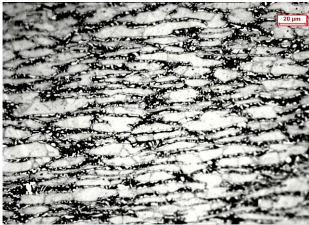
CAMPIONE DEFORMATO AL 35%
