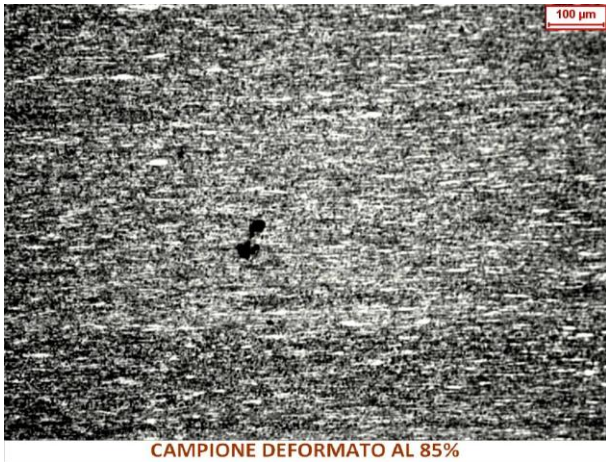
Figura 3.6 Micrografie ottiche a 100x del materiale sottoposto a laminazione per riduzioni di spessore del 10%, 25%, 35%, 55%, 65% e 85% in confronto con il campione tal quale, TQ e successivamente trattato termicamente a 900°C per 10minuti.
