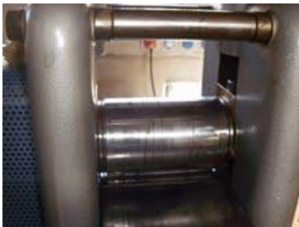
Figura 2.1: Rulli del laminatoio per la deformazione plastica dei provini
