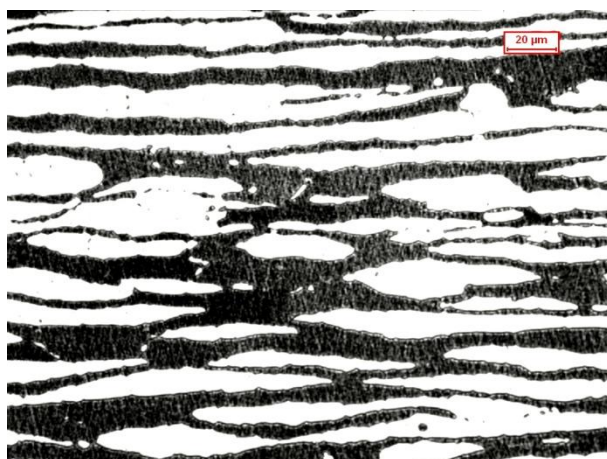
Figura 3.2 Micrografia ottica a 500x del materiale allo stato di fornitura dopo attacco Beraha: sezione trasversale.
