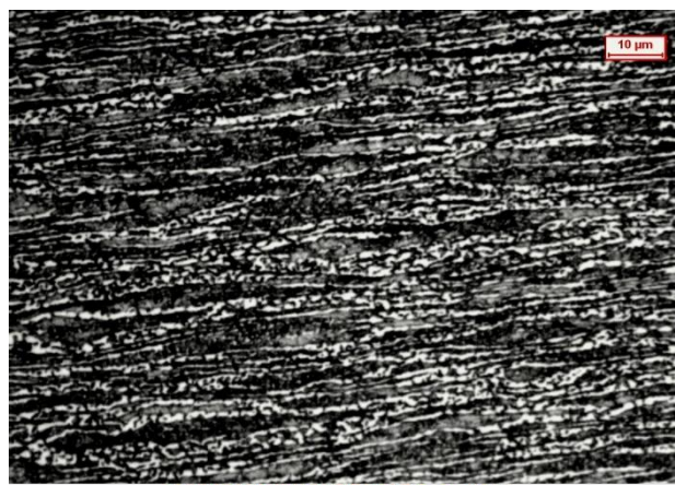
CAMPIONE DEFORMATO AL 85%
