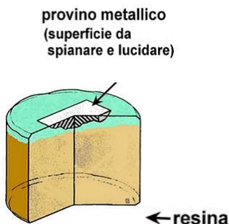
Figura 2.7: Provino metallico inglobato nella resina termoindurente
