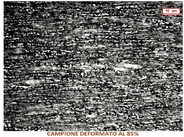
Figura 3.7 Micrografie ottiche a 500x e 1000x del materiale sottoposto a laminazione per riduzioni di spessore del 35%, 55%, 65% e 85% e successivamente trattato termicamente a 900°C per 10minuti.
