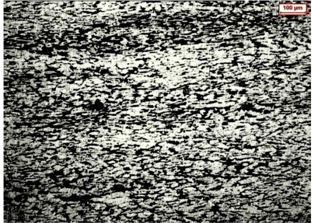
CAMPIONE DEFORMATO AL 10%
