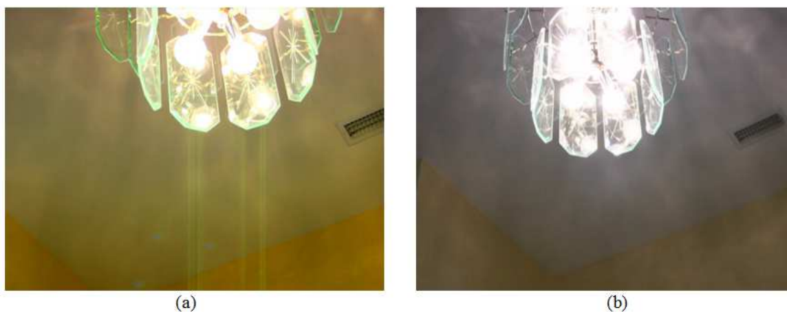
Figura 26: Effetto di blooming (colonne di luce) presente nel sensore CCD (a) e assente in quello CMOS (b)
