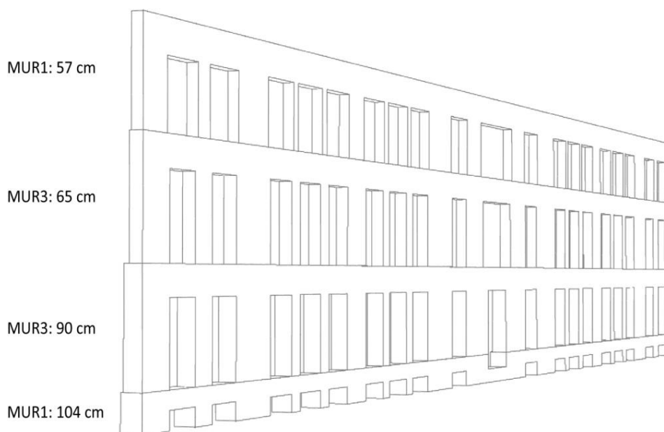
Fig. 5.4: Identificazione delle tipologie murarie e variazione degli spessori
