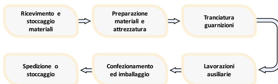
Figura A.3 – Esempio ciclo produttivo delle facciate a cellule – Z
