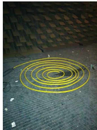
(d) Long medium-sized tube (25 m, inner diameter 1.9 cm).
