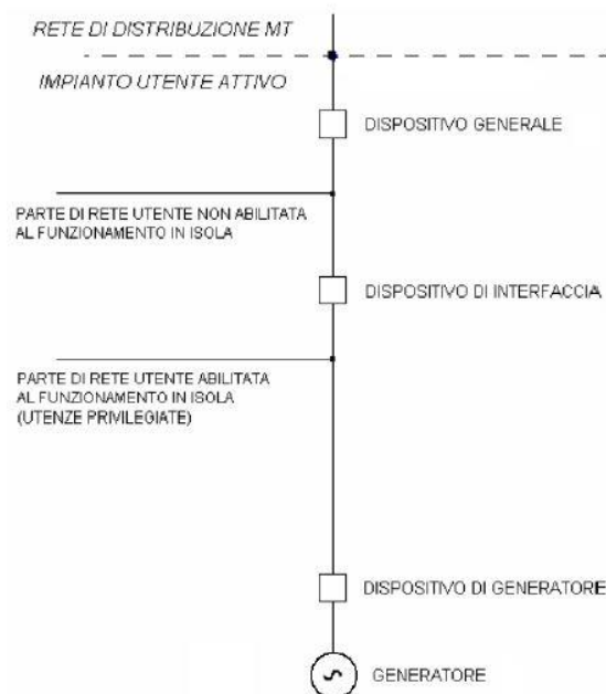
Figura 2.7: Schema di collegamento di un impianto di produzione funzionante in parallelo alla rete.
