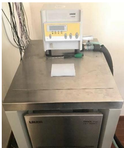
Figura 6: Bagno termostatico utilizzato per regolare la temperatura dell'acqua all'ingresso della sezione sperimentale [11]
