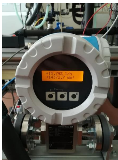
Figura 14: Esempio di misuratore di portata volumetrico magnetico utilizzato per misurare la portata d'acqua alla sezione sperimentale
