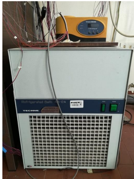
Figura 19: Bagno termostatico utilizzato per la taratura delle termocoppie
