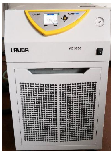
Figura 7: Chiller utilizzato per regolare la temperatura dell'acqua e glicole all'ingresso del post-condensatore [11]
