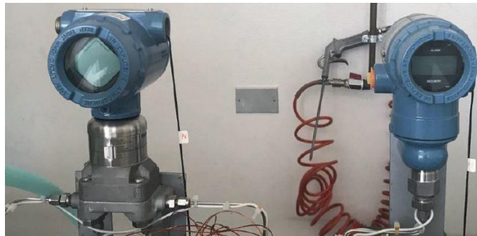
Figura 13: A sinistra è mostrato un misuratore di pressione differenziale, caratterizzato da due prese di pressione. A destra invece c'è un misuratore di pressione assoluta con un solo collegamento all'impianto [11]
