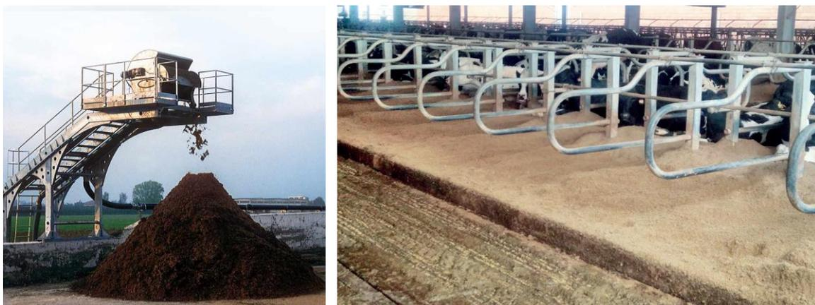
Fig. 1.7 (a sx) - separatore per letame (Foto: doda.com); Fig. 1.8 (a dx) - cuccetta con separato solido (Foto: crpa.it)
