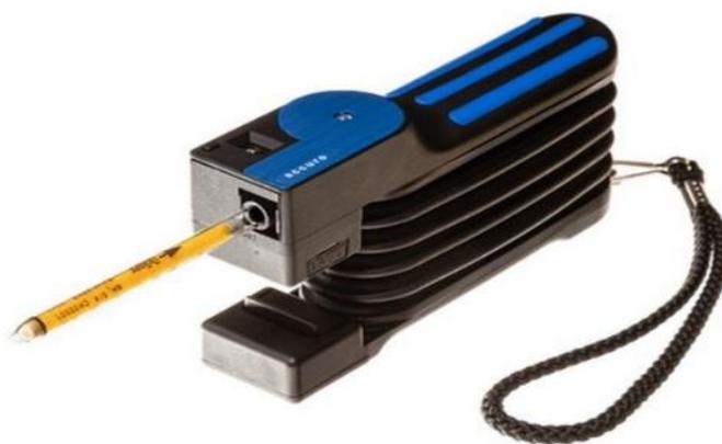
*Fig. 3.4 – Pompa manuale Dräger utilizzata durante la prova con relativa fiala colorimetrica inserita*
