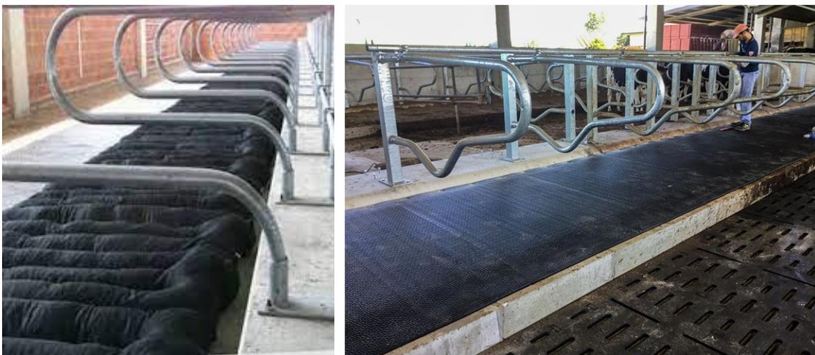
Fig. 1.13 - stalla con materassino a sinistra e con tappetino a destra (Foto: crpa.it e omfontana.it)
