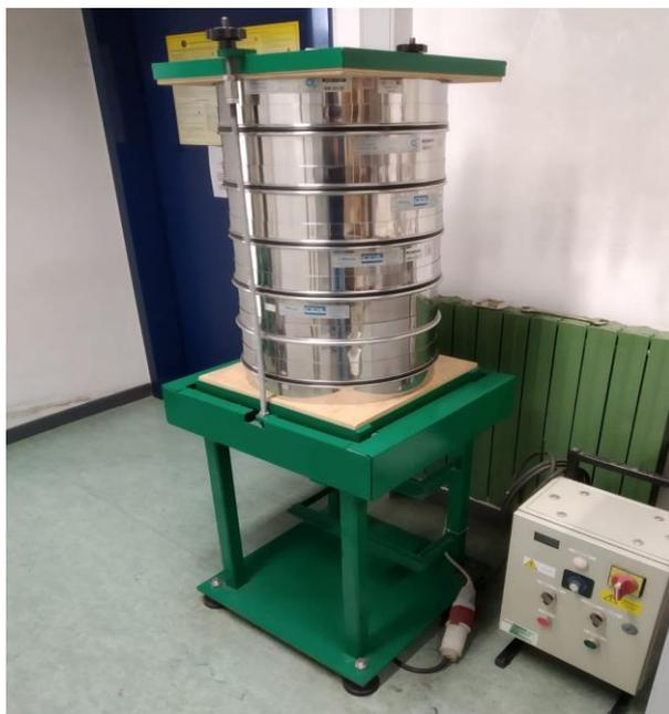
*Fig. 3.1 – Vaglio elettrico oscillante utilizzato durante la prova*
