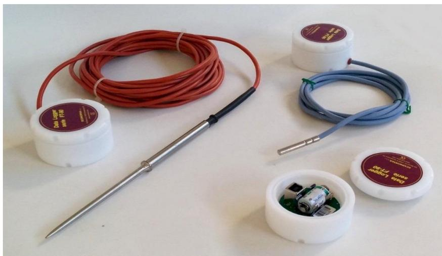
*Fig. 3.5 – Datalogger con sonda utilizzati per il rilevamento delle temperature dei cumuli*
