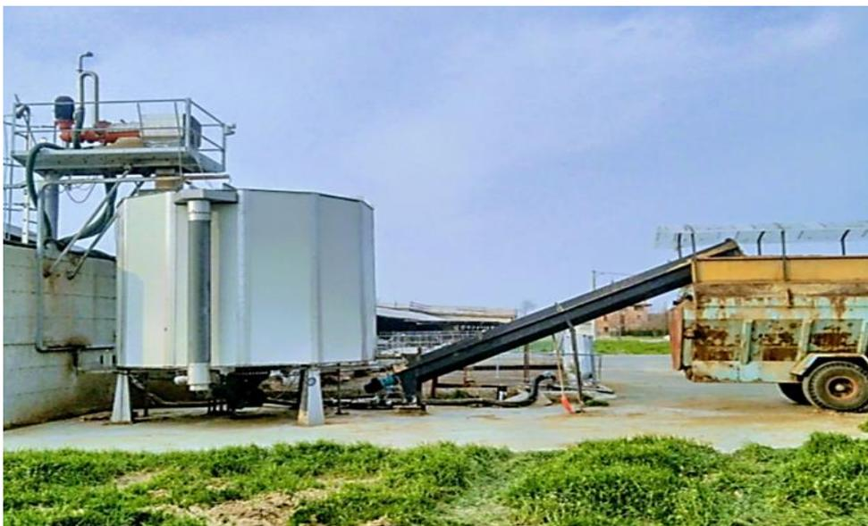
Fig. 1.10 - Biocella igienizzante per la disinfezione del separato solido (Foto: crpa.it)
