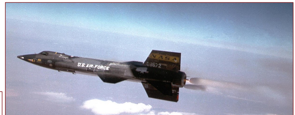
Fig.17 X-15, usava H_2O_2 in decomposizione per muovere il sistema di pompaggio del combustibile
