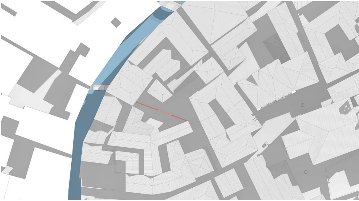
Figura 84 Planimetria del modello tridimensionale dell'isola nel 1696, evidenziato in rosso il muro di confine tra proprietà pubbliche e private (elaborazione di T. Sandon)
