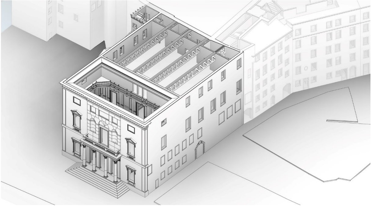
Figura 26 Spaccato assometrico del secondo piano del foyer (elaborazione di T. Sandon)
