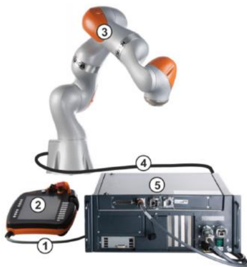
Figura 41 Sistema KUKA LBR iiwa 14 R820. 1) Cavo di connessione alla smartPAD; 2) pannello di controllo KUKA smartPAD; 3) manipolatore; 4) cavo di connessione alla KUKA Sunrise Cabinet; 5) controllore del robot KUKA Sunrise Cabinet
