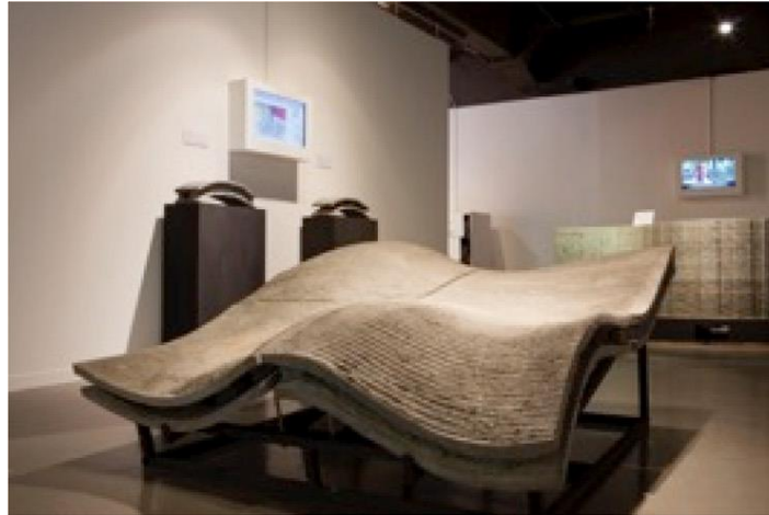
Figura 17 pannello prefabbricato in cemento realizzato con 3DCP [16]
