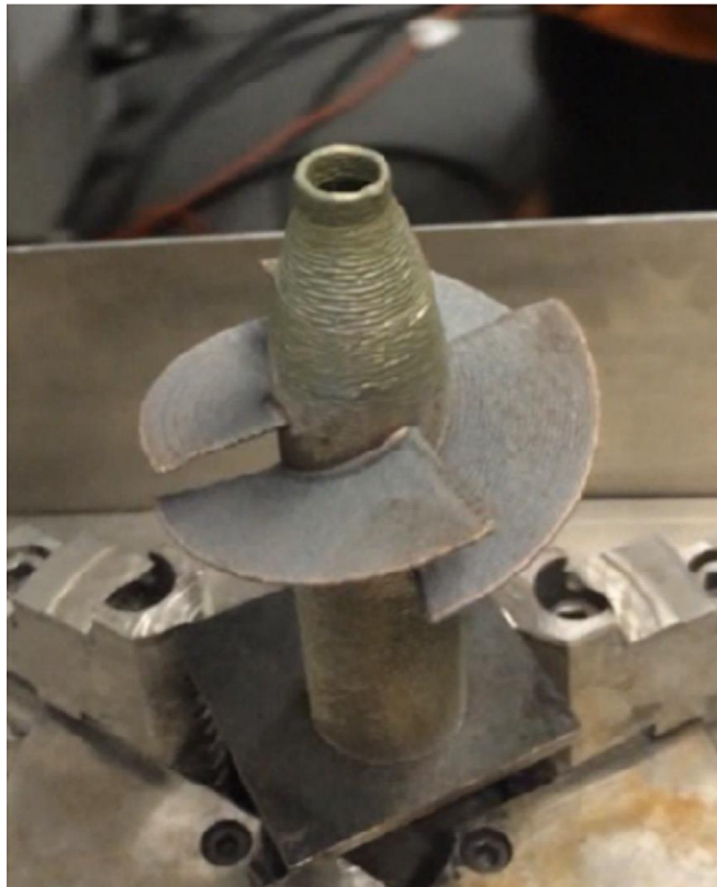
Figura 24 Elica stampata con DMD, le pale sono state stampate per strati curvi a partire dalla superficie cilindrica del corpo centrale [6]
