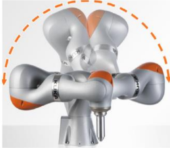
Figura 43 Illustrazione schematica del null space motion. La posizione finale del braccio robotico rimane fissa nonostante il movimento dei giunti.
