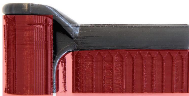
Figura 13 Supporti per sostenere gli elementi di un manico stampato con FDM [13]
