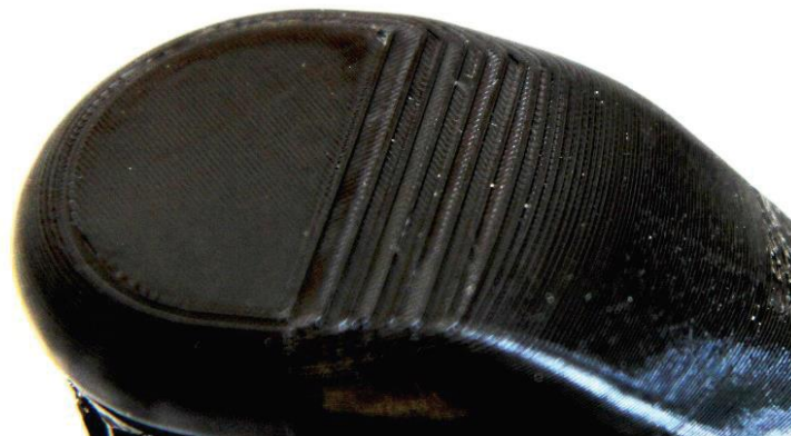
Figura 11 Effetto stair-step su una superficie curva stampata depositando strati orizzontali [13]
