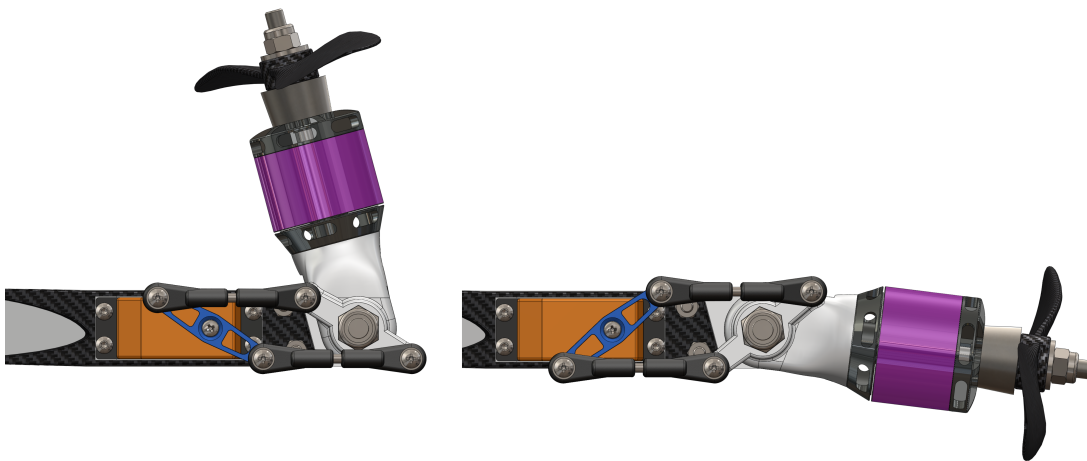
Figura 2.11: Dettaglio del meccanismo di rotazione dei motori
