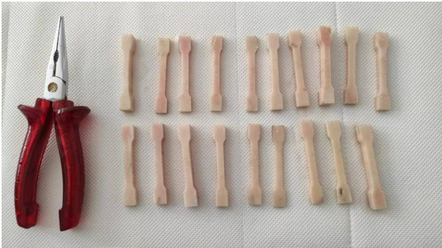
Figura 3.12: Foto di una parte dei provini ossei realizzati per questo studio, sagomati mediante taglio ad acqua e soggetti a fresatura finale.
