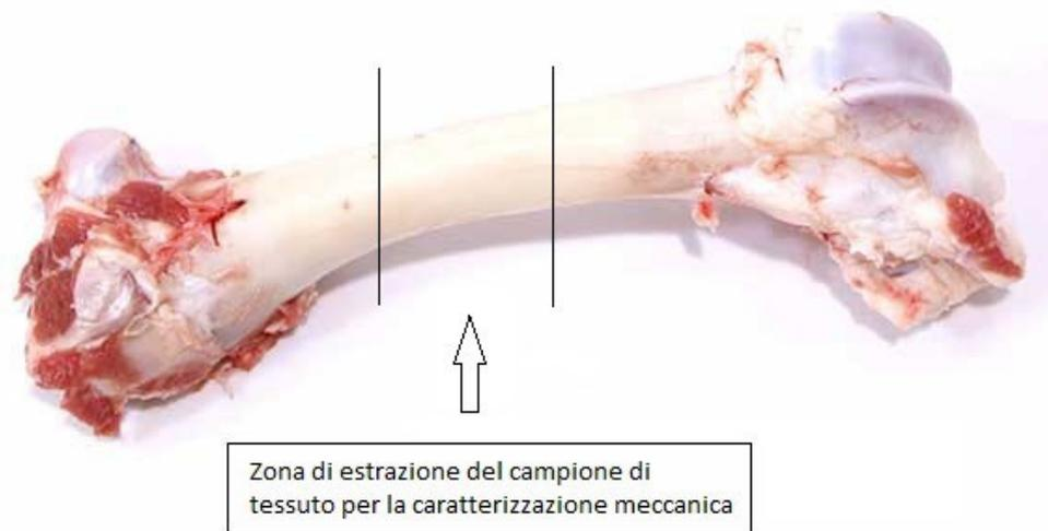
Figura 3.10: Illustrazione della zona di prelievo dei campioni ossei su femore di bovino.
