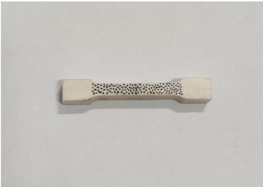
Figura 3.13: Foto illustrativa del pattern realizzato manualmente con pennarello su uno dei provini ossei.
