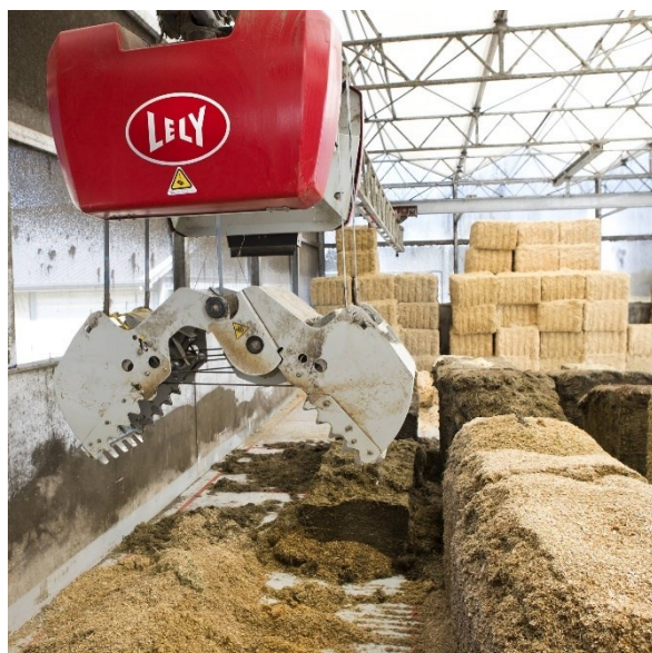
Figura 19. Sistema di alimentazione robotizzato - cucina e pinza di carico (Lely).
