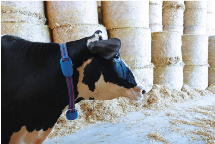
Figura 16. Collare su cui possono essere inseriti sensori per la rilevazione dell'attività ruminale (ruminometri) e dell'attività fisica (accelerometri) (Lovarelli & Guarino).
