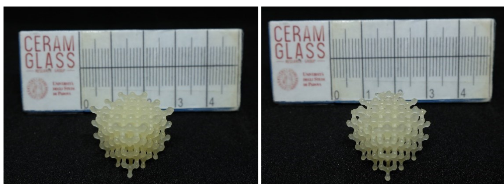
Figura 48: A sinistra, foto di un campione da polimero preceramico contenente FS con struttura a diamante. A destra, foto di un campione da polimero preceramico non contenente FS con struttura a diamante.
