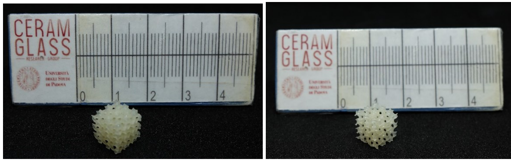
Figura 49: A sinistra, foto di un campione da polimero preceramico contenente FS con struttura a giroide. A destra, foto di un campione da polimero preceramico non contenente FS con struttura a giroide.
