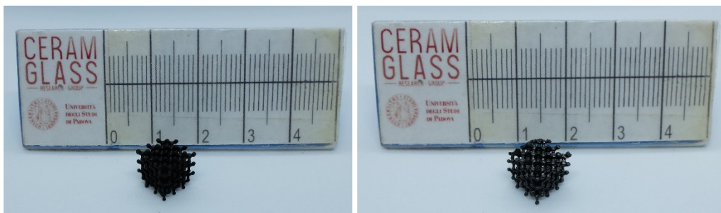
Figura 50: A sinistra, foto di un campione da polimero preceramico contenente FS con struttura a diamante. A destra, foto di un campione da polimero preceramico non contenente FS con struttura a diamante.
