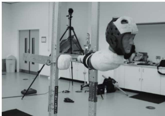
Figura 4.6 Hybrid II Crash Dummy utilizzato per calcolare la forza d'impatto che può generare un calcio eseguito all'altezza della testa dell'avversario
