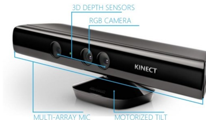
Figura 4.4 Esempio di sensore Kinect, dotato di un sensore di profondità (3D), una telecamera RGB, un array di 4 microfoni ed un motore per la regolazione dell'inclinazione
