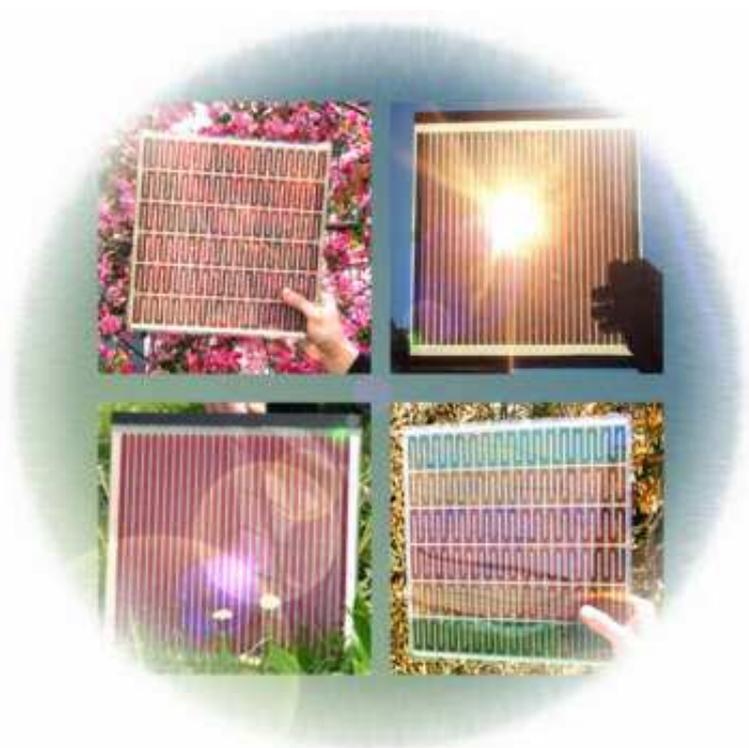
**Figura 5.5:** Esempi di celle sensibilizzate con colorante. Si nota la loro caratteristica di semitrasparenza.
