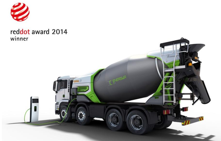
**Figura 2.6:** Autobetoniera con sistema ibrido plug-in (Fonte [www.cifa.com](http://www.cifa.com)).
