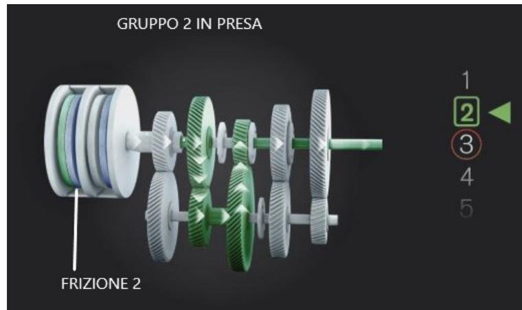
**Figura 1.33:** Cambio I-Shift, selezione della seconda marcia *Renault*
