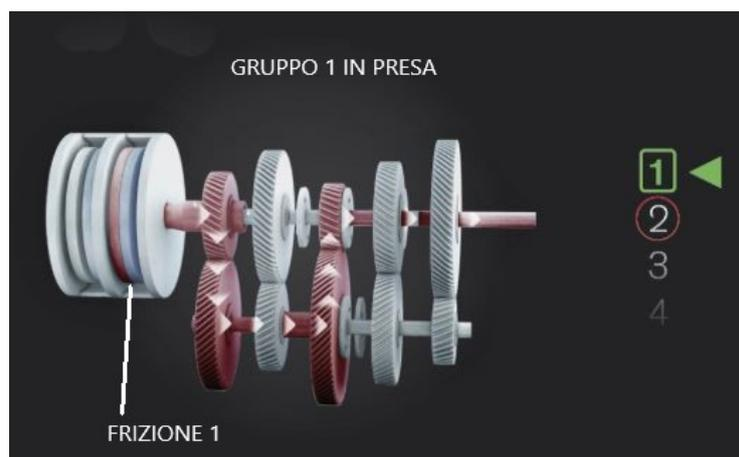
**Figura 1.32:** Cambio I-Shift, selezione della prima marcia *Renault*
