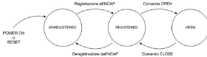
Figura 1.3: Diagramma di stato del WTIM
