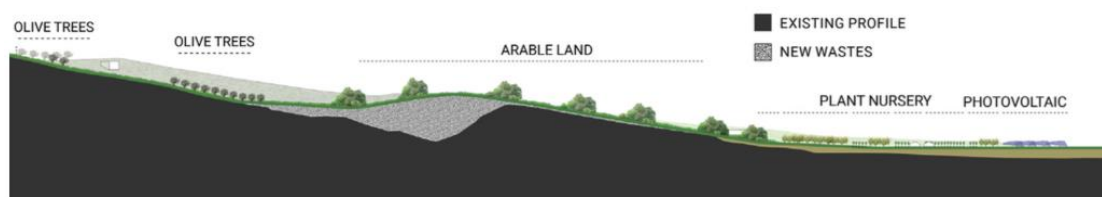
Figura 20: Sezione trasversale di una discarica. I rifiuti vengono utilizzati come materiale plastico per modellare il terreno.
