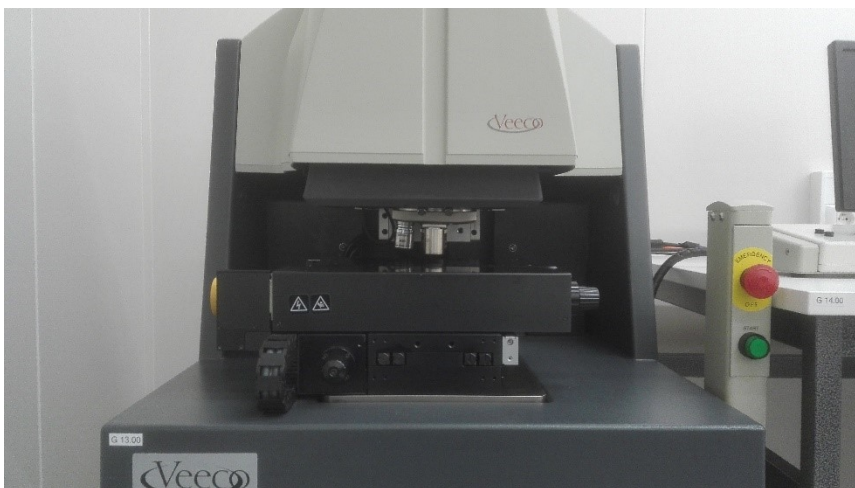
Figura 3.6: Interferometro utilizzato per effettuare le scansioni
