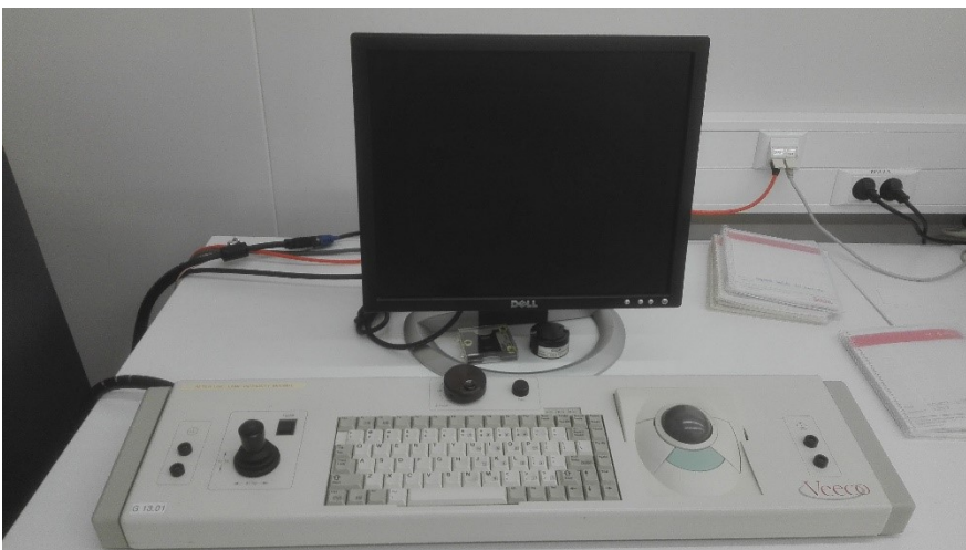
Figura 3.8: Tastiera con joystick per muovere la piattaforma con il campione. Con il monitor si osservavano le proprie operazioni
