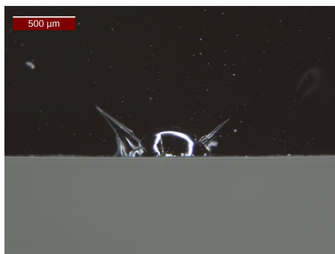
Figura 4.20: cricca da abrasione; Line Simulator AGR 30 secondi, bottiglie vuote, bagnate, con cuneo per l'abrasione del fondo, slittamento 20% da 35 giri/min.
