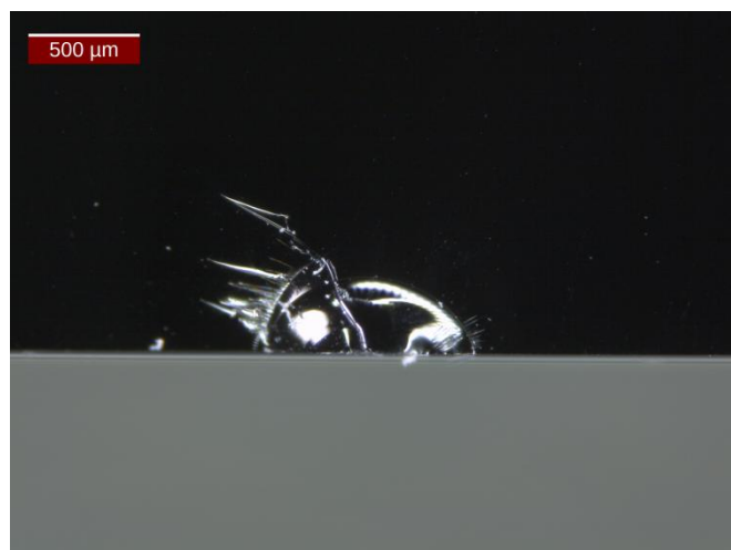
Figura 4.21: cricca da abrasione; Line Simulator AGR 1 minuto, bottiglie vuote, bagnate, con cuneo per l'abrasione del fondo, slittamento 20% da 35 giri/min.
