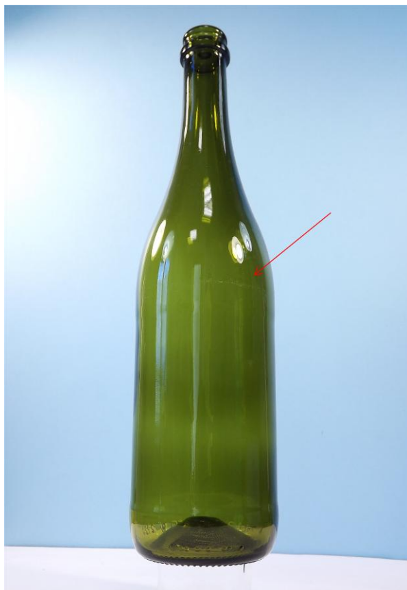
Figura 4.23: bottiglia simulata 5 minuti. La freccia rossa indica i danneggiamenti da abrasione ben visibili sulla superficie della bottiglia, nella zona del contatto spalla.
