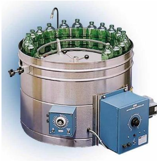
Figura 4.4: AGR Line Simulator. Le bottiglie vengono fatte ruotare all'interno del simulatore a velocità determinate. Il mutuo sfregamento provoca danneggiamenti sulla superficie esterna dei contenitori.
