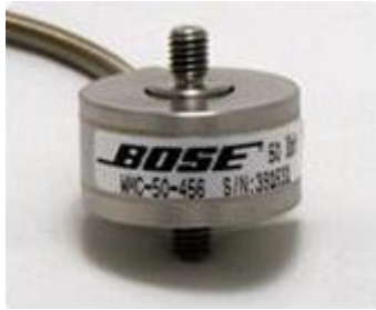
Fig. 2.3 – Cella di carico da 50 lb.
